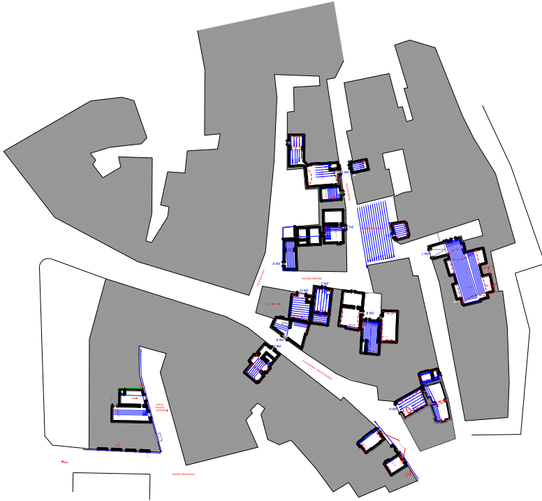
Fig. 17: Ubicazione dei profili GPR
